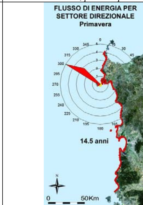
Fig 3.12.12 Media annuale del flusso lordo di energia in Kw/m per settori direzionali di 15^\circ - tratto costiero da C.po del Falcone a C.po Altano- dati triorari, periodo: primavera
